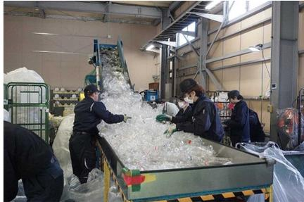
回収したリサイクル資源物は、自前の処理施設(エコセンター)で選別・圧縮処理しています
